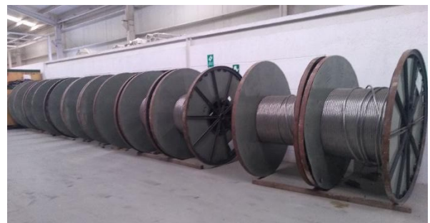
Fig. 3 Carretes de conductores en el almacén de Santamarta del Enlaza
