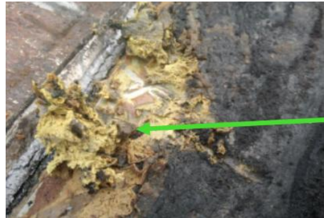
Figura 4. Análisis de residuos y su coloración amarilla permitió concluir que se tenían compuestos azufrados.
