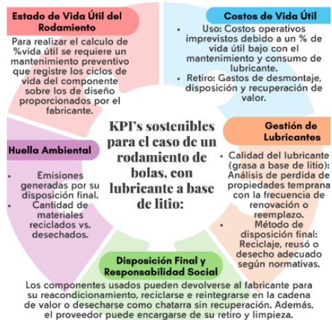
Fig 7. KPI's sostenibles para el caso de un rodamiento de bolas, con lubricantes a base de litio.
