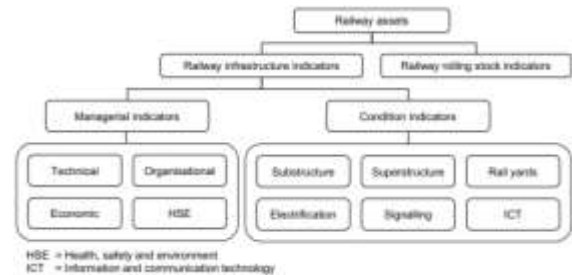
Fig. 3 Estructura de los Indicadores de desempeño de la Infraestructura de Ferrocarriles. Tomada del documento Performance indicators of railway infrastructure
