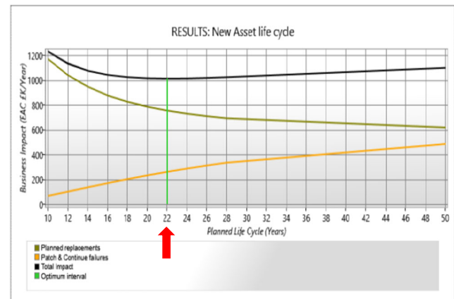
Fig. 9. Tiempo óptimo de reemplazo del activo actual por uno de nuevo diseño y monto del impacto al negocio. Fuente: Tomado de archivo empresarial TWPL. [imagen] TWPL, (2023). [7]
