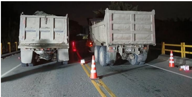
Fig. 3. Prueba para la (i) Verificación de la capacidad de carga.
