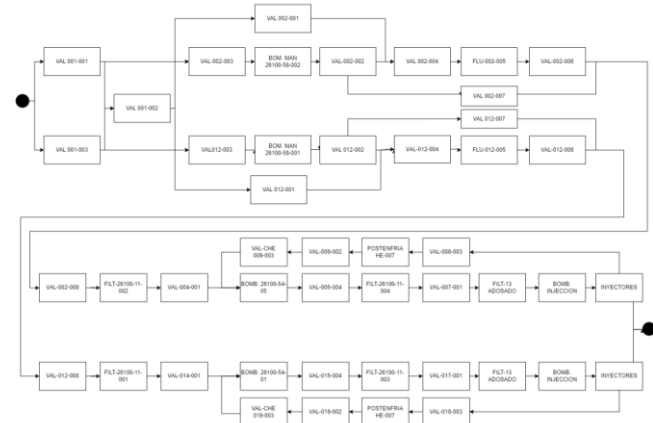
Figura 2. Diagrama de Bloques Funcionales del Sistema de Combustible.
