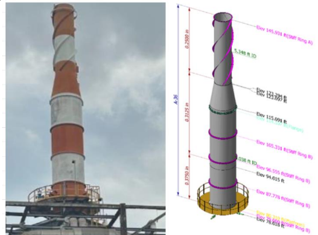
Figura. 5 modelamiento chimenea GRB
