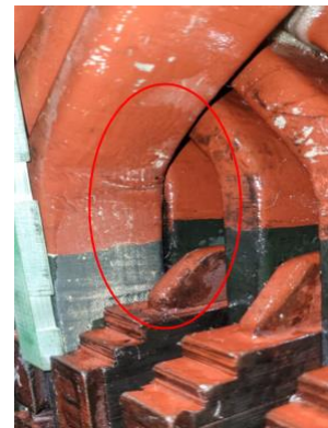
Figura 10. Separación entre bobinas del estator.
