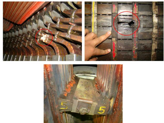
Figura 4. Daños en el núcleo del estator del generador.
