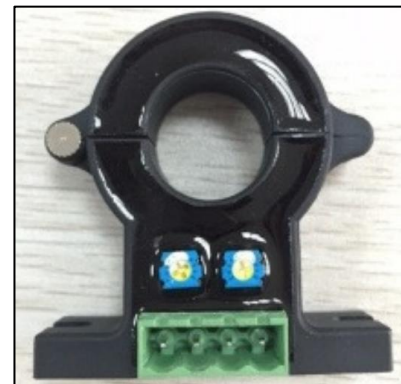
Fig. 2. Sensor de corriente usado en la solución por banco de baterías.
