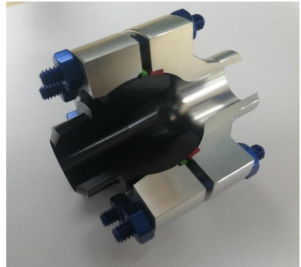
Fig 6. Esquema simple con anillo cónico (color rojo) Taper Lok.
