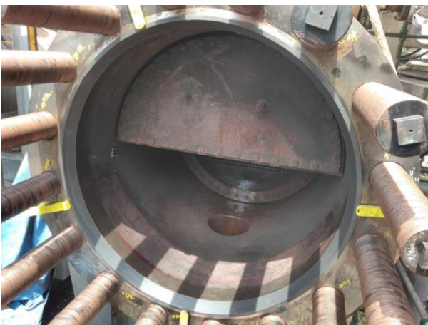
Fig 10. Posicionamiento anillo cónico Taper Lok.
