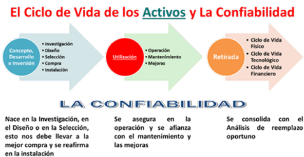
Fig. 3 Relación entre el Ciclo de Vida de los Activos y la Confiabilidad
