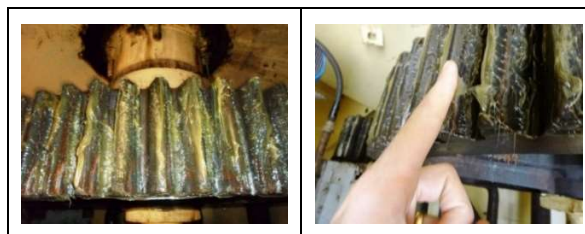
Fig. 10/11 – Coroa e pinhão de cristalizador de açúcar: engrenagens horizontais
