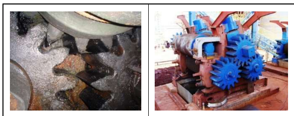
Fig. 14/15 – Rodetes de acionamento de terno de moendas
