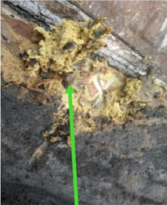
Se encontraron depósitos que contenían fluoruros orgánicos e inorgánicos y compuestos azufrados en las paredes del equipo.
