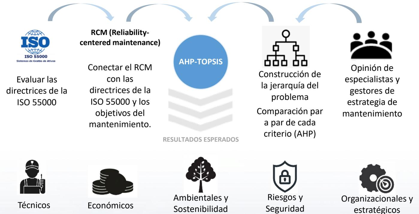
Figura 3 – Macroprocesos para priorizar los activos ferroviarios en la gestión del mantenimiento y resultados esperados
